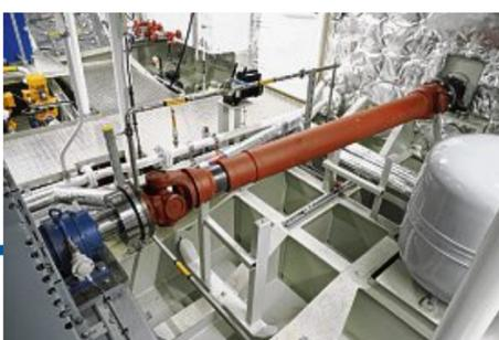
**Die Gelenkwelle** verbindet das hydraulische Wandlergetriebe (ganz links) mit dem Antrieb. Ohne das Getriebe könnte das Schiff gar nicht aus dem Stillstand anfahren, weil das den Motor gewissermaßen abwürgen würde. Dieser Anblick ist übrigens einmalig: Später wird die Antriebswelle noch mit einer Abdeckung versehen.
