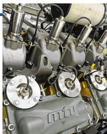
**Zündkerzen** an einem Motor mit Diesel-Genen: Die braucht es, weil dieses eigens für die „Richmond“ umgebaute Hightech-Aggregat von MTU Friedrichshafen kein Selbstzünder ist. Hier sieht man eine Seite des Achtzylinders mit rund 1000 PS. An beiden Enden des Schiffs ist je ein Motor eingebaut.
