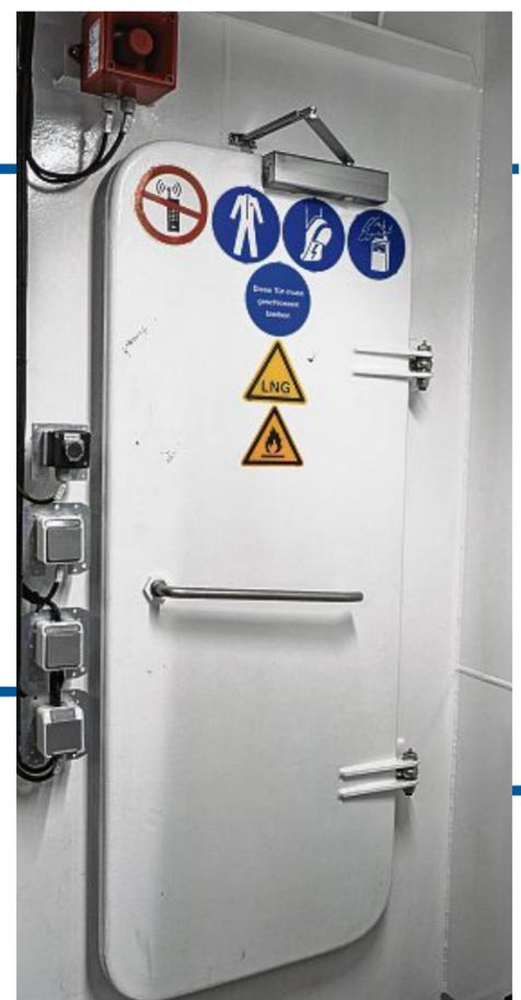
**Explosionsgefahr** herrscht hinter dieser Tür: Rauchen ist unter Deck strengstens verboten. Hinter dieser Tür lagert so viel eiskaltes Flüssiggas in Thermo-Tanks, dass die Fähre eine ganze Woche damit fahren kann. Methan erfordert einen anderen Umgang als Diesel.
