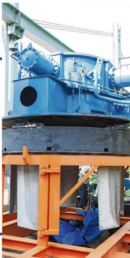
**Der Antrieb**, hier ein ausgebauter Voith-Schneider-Wendepropeller, verleiht dem Schiff beste Manövrierfähigkeit. Auf einer Kreisbahn rotieren fünf verstellbare Schaufeln. Übrigens werden stets beide Propeller betrieben. Dabei werden zwei Drittel der Kraft vom vorderen und ein Drittel vom hinteren Propeller erzeugt.
