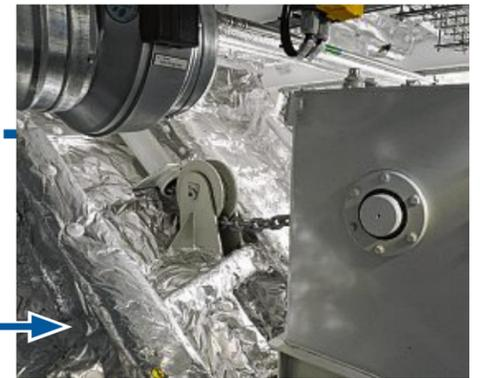
**Die Ankerwinde** wird ebenfalls elektrisch angetrieben. Die Ankerkette ist 100 Meter lang und wird neben dem Antrieb liegend gelagert. Eine Trommel für so eine Kette wäre riesig! Inmitten des Sees kann die „Richmond“ nicht ankern, dafür ist er zwischen Meersburg und Staad zu tief, aber näher an Land funktioniert es.
